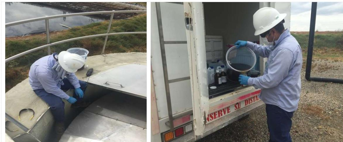
*Toma de muestras para análisis de laboratorio del reactor UASB*
