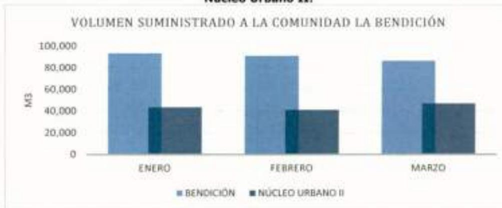
Como se puede observar en la **Gráfica 6**, el sistema de bombeo Pozo Núcleo Urbano II apoya en el suministro de agua potable cuando la capacidad del sistema la bendición no da abasto, además, mantiene suministro las 24 horas y 16 horas de suministro por sistema La Bendición.
