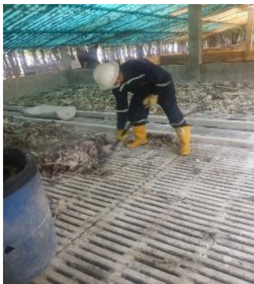
Fotografías 52-55: deshidratación, volteo y retiro de lodos secos para disposición final
