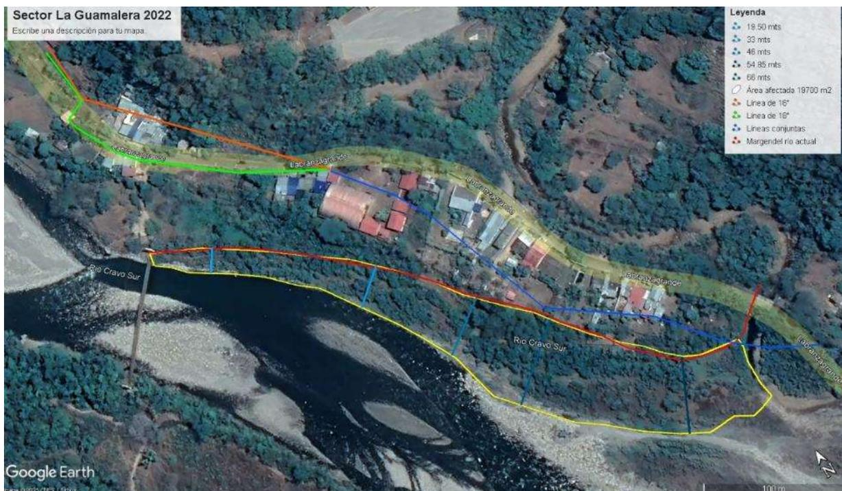
Imagen Google Earth del 22 de febrero de 2022, Implantación de tuberías y determinación de área afectada
