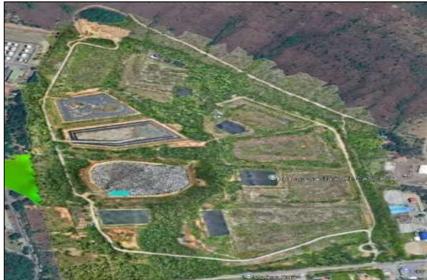
La trinchera 10 estuvo en operación hasta el 19 de octubre de 2024, se está a la espera a que se determine con topografía la cota de llenado correcta, para proceder a iniciar labores de cierre progresivo el cual consistirá en la impermeabilización de la trinchera, construcción de chimeneas, para que entre en fase de asentamiento.
