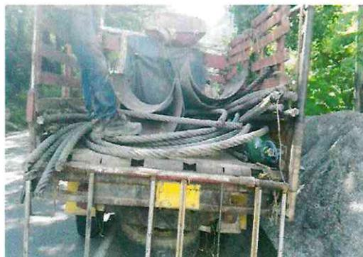
Hurto de Cable 1 - 7/8" y tubería metálica de 26" e = 3/8"
