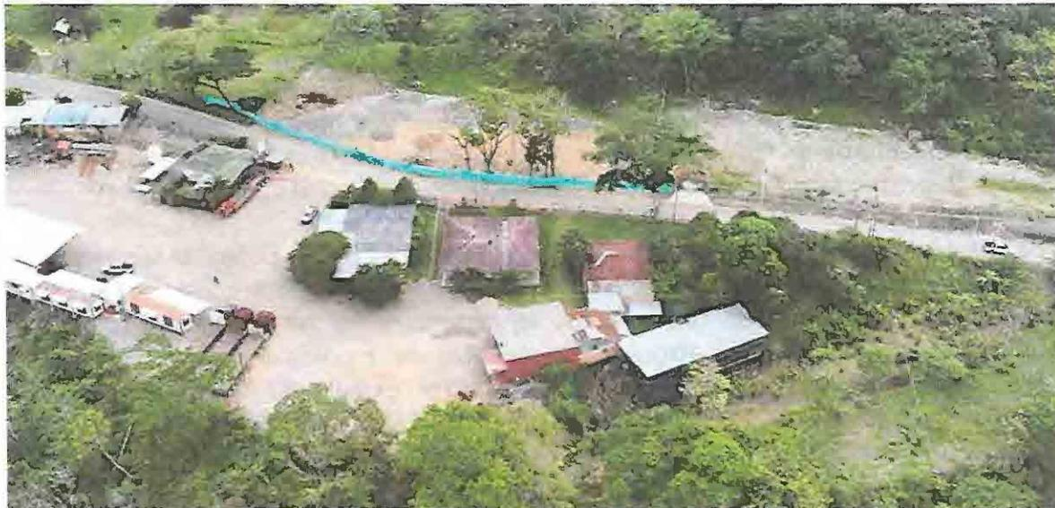
*Foto 26 Afectación fajas reserva sector escuela La Guamalera. Cerramiento, excavaciones y explanaciones. Tubería de aducción de 18" y 16" coordenadas 5°25'17.377" N 72°26'52.117" W*
