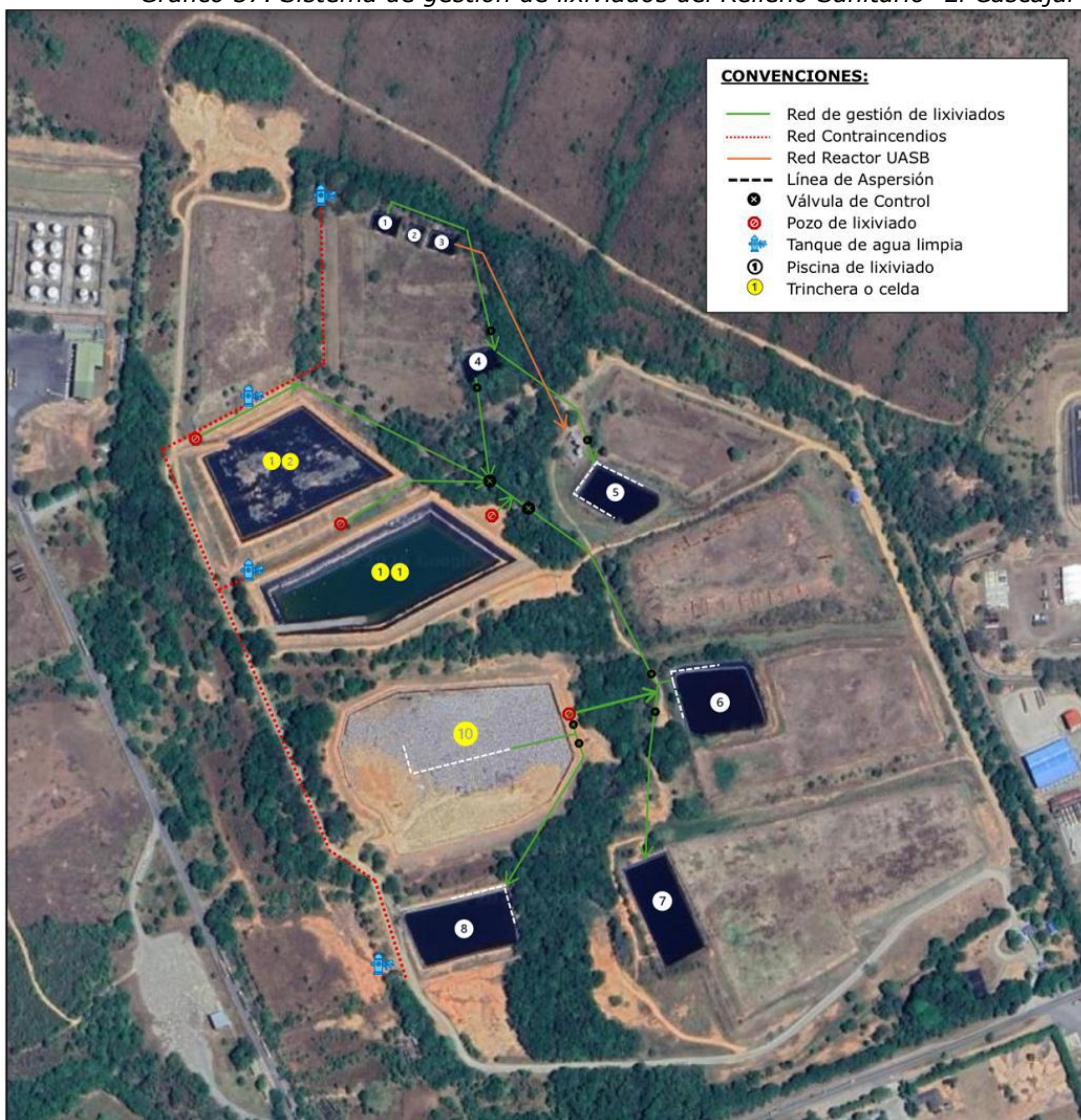
Grafico 37. Sistema de gestión de lixiviados del Relleno Sanitario “El Cascajar”
