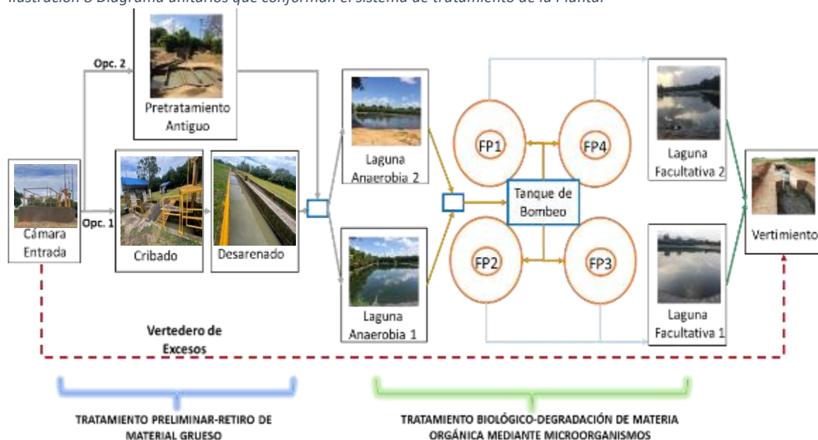
Ilustración 8 Diagrama unitarios que conforman el sistema de tratamiento de la Planta.
